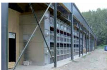
**L'essiccatore** possiede da 1 a 6 sezioni di piastre perforate che ruotano grazie a una catena a rullo. L'essiccazione inizia sul primo strato, la pollina cade poi nell'ultimo strato ed è rimossa da una coclea.
